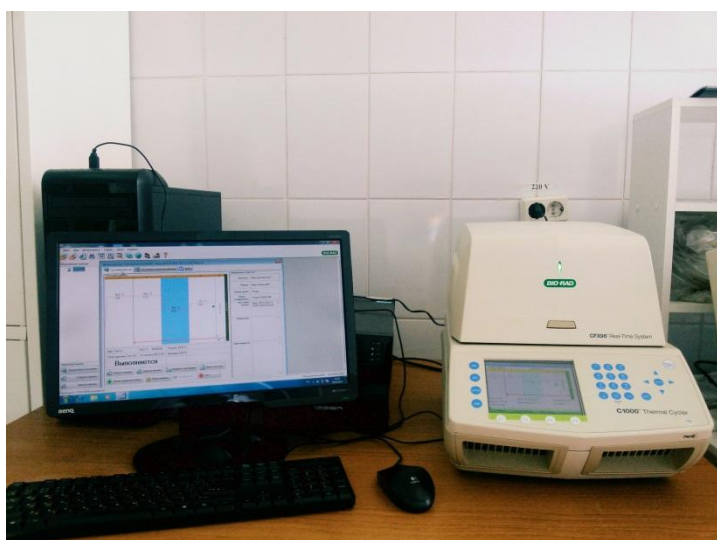
Рисунок 9 - Амплификатор для проведения ПЦР в режиме реального времени и компьютер для обработки полученных результатов.
