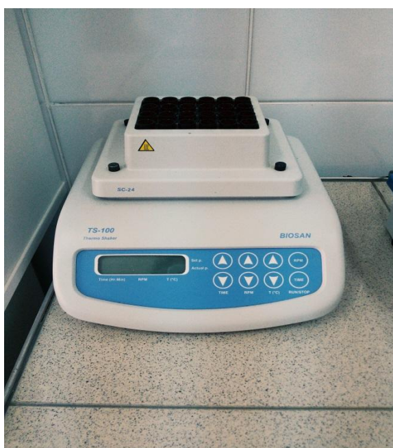
Рисунок 4 - Термошейкер для нагревания и встряхивания биопроб при выделении ДНК.
